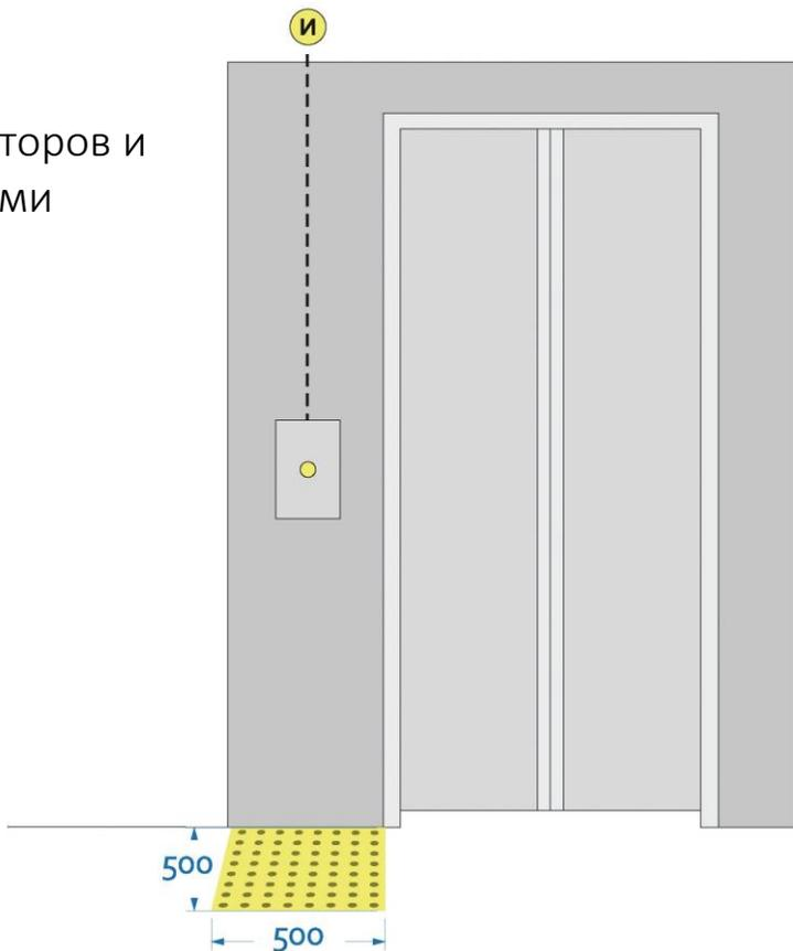
Кнопки вызова и управления движением лифта должны быть выделены цветом и промаркированы рельефными арабскими цифрами и шрифтом Брайля с указанием номеров этажей, а также другой необходимой информации (на кнопках или над ними).
